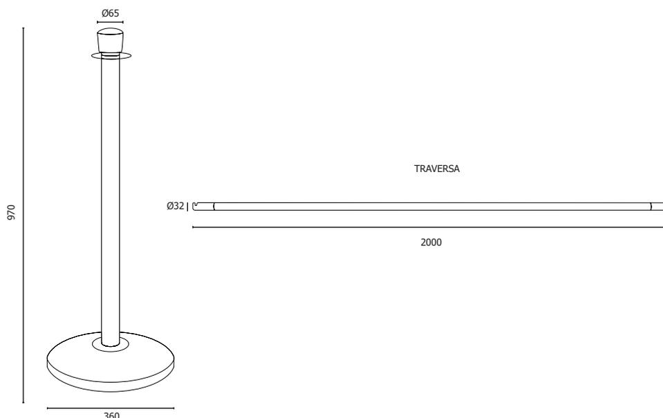
Colonnine in acciaio con finitura lucida cromata porta banner personalizzabile, base in cemento con copertura superiore in acciaio inox finitura lucida e guarnizione inferiore anti-scivolo.
